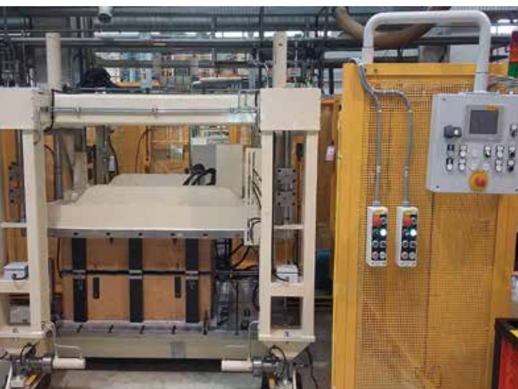
Zabezpieczone urządzenie do kształtowania elementów miękkich metodą wtrysku piankowego.
