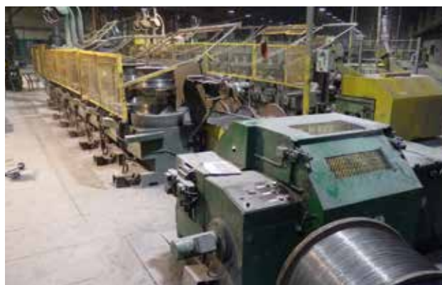
Rys. 7. Strefa nawijarki przed modernizacją
